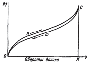
Рис. 10.18. Характеристика плоской спиральной пружины
