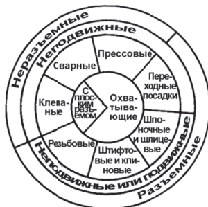
Рис. 2.16. Схема наиболее распространенных типов соединений
