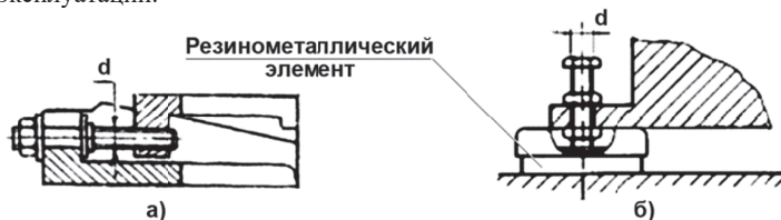
Рис. 2.17. Опоры для установки станков и машин на фундаменте: а – клиновая; б – виброопора
